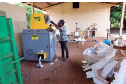
EPS é colocado na máquina redutora de volume
