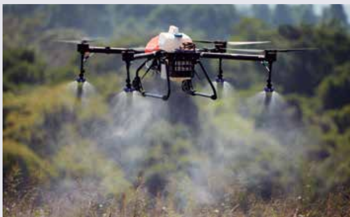
Aplicação localizada de defensivo por drone
